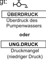
Durch Einwirken auf die Taste können die **zwei Bar** des **Absinkens des Drucks** (niedriger Druck) geändert werden. Diese Änderung wird gelöscht, wenn der Motor angehalten wird.
